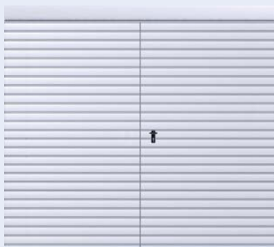
Dvoukřídlá závěsná posuvná vrata vyplněná plechem T-10, systém výplně vodorovný
